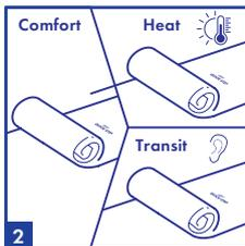
используйте специальную подложку HEAT при температуре свыше 45°C. Виниловое покрытие Quick-Step предназначено для монтажа в отапливаемых помещениях (> 5°C), желательно при нормальной комнатной температуре. Покрытие Quick-Step Vinyl не подходит для монтажа в соляриях, на сезонных площадках, в жилых прицепах, на плавучих судах или в других неотапливаемых помещениях.
