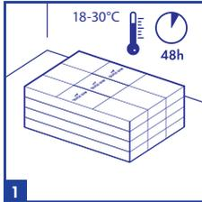
Монтаж необходимо проводить при температуре 18–30°C. Виниловому полу Quick-Step необходима акклиматизация в помещении монтажа при температуре 18–30°C в течение 48 часов или более перед монтажом. Эту температуру пола и воздуха в помещении необходимо поддерживать перед монтажом, во время него и не менее 24 часов после завершения работ.
