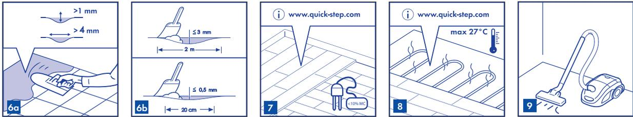
использовать переходный профиль. Контрольное соединение чернового пола можно закрыть защелкивающимся виниловым полом Quick-Step. Деформационные швы здания необходимо повторить при монтаже винилового покрытия Quick-Step. Кроме того, необходимо использовать профиль.
